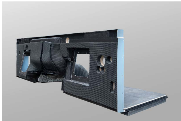
PAROI FRONTALE DU MOTEUR ENTIÈREMENT ISOLÉE
